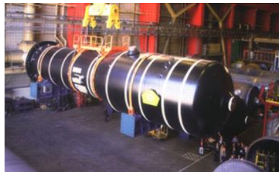
Générateur de vapeur 900 MW à l'usine Framatome ANP de Chalon-Saint-Marcel
